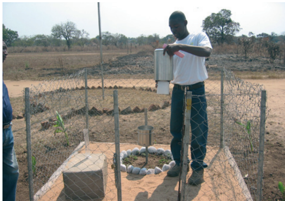
Beim Flutwarnsystem in Buzi, Mosambik, messen freiwillige Helfer drei Mal am Tag die Niederschlagsmengen und funken die Ergebnisse in eine Zentrale.
